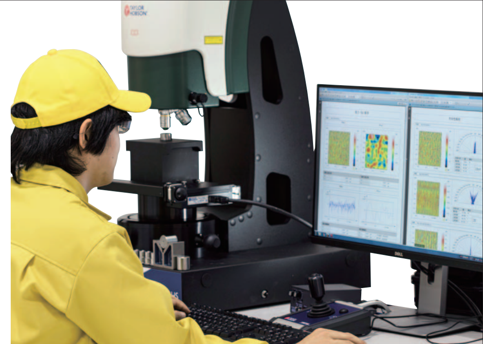
三次元表面形状測定 Taylor Hobson CCIMP-HS非接触3D光学式プロファイラ
